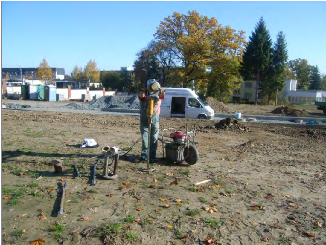
Bild 1: Abteufen einer Rammkernsondierung als zusätzlicher Aufschluss
