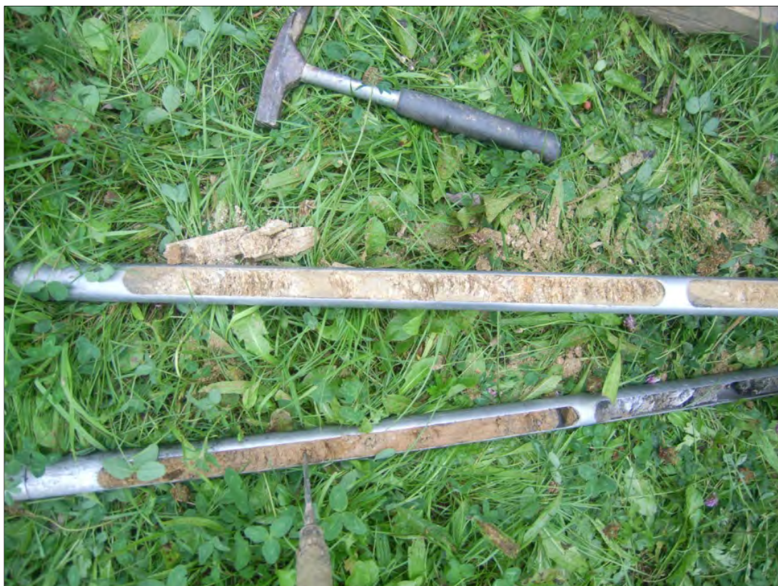
Bild 2: mit Rammkernsondierung erbohrtes Kernmaterial zur Dokumentation des Schichtenprofils
